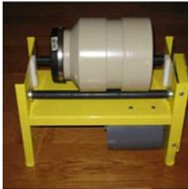
**Gambar 6.6** Ballmill untuk persiapan bahan glazur
