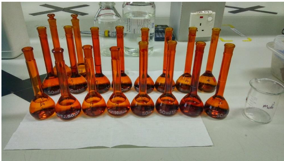
Gambar 3.6 Preparasi Larutan Standar dan Larutan Sampel
