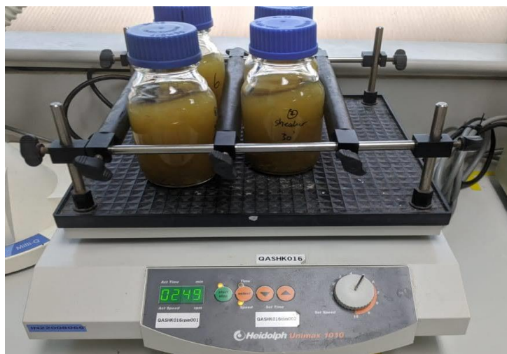
Gambar 3.4 Proses Maserasi Serbuk Jahe dengan Solven selama 1 Jam
