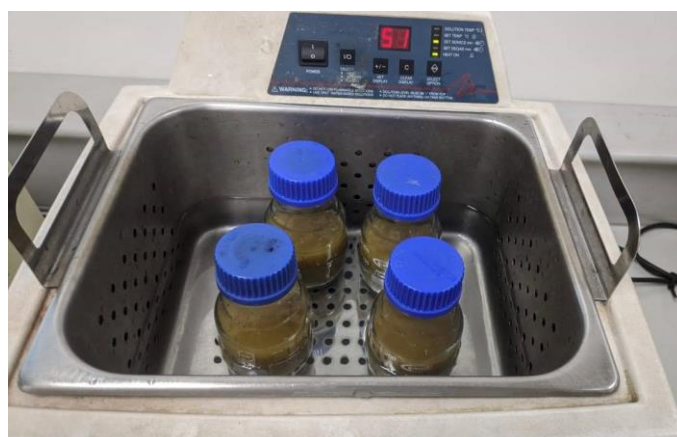
Gambar 3.5 Proses Ekstraksi Ultrasonik 40 dan 50 kHz
