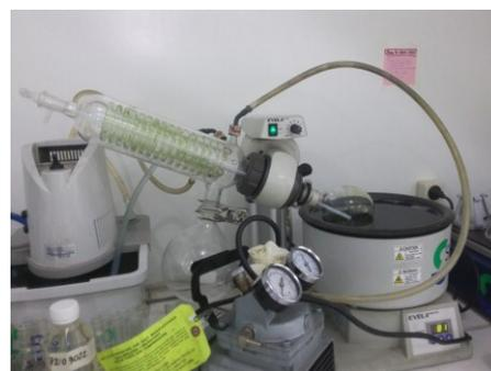
Gambar 4. Pemisahan zat aktif dari solven dengan rotary evaporator
