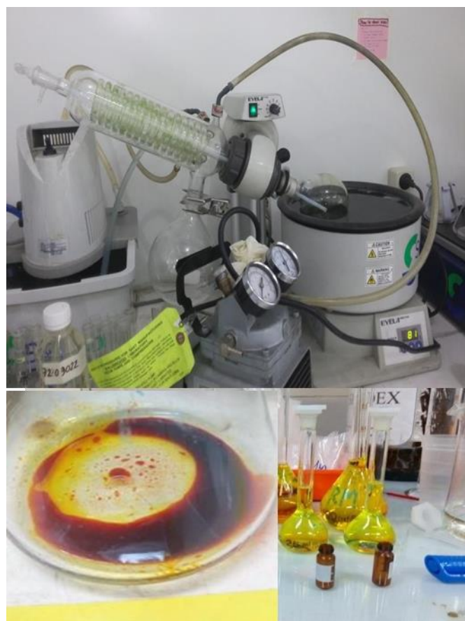
Gambar 3. Hasil pemisahan Solven dan produk kurkumin dengan alat Rotari Evaporator
