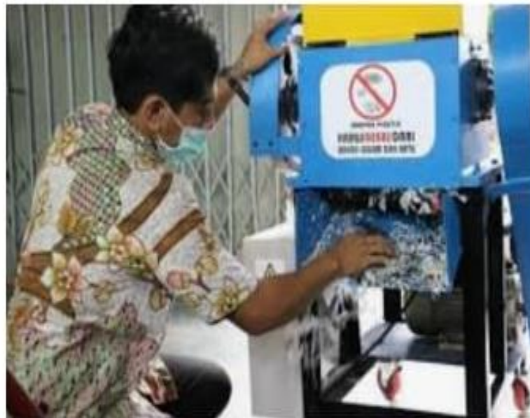
Gambar 3.2. Proses pencacahan plastik
