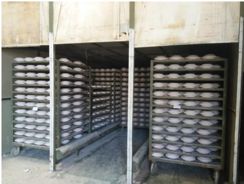
Gambar 1. Ruang pengeringan tipe rak untuk cetakan keramik kapasitas 2880 cetakan
