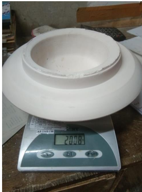
Gambar 5. Penimbangan cetakan setelah proses pengeringan
