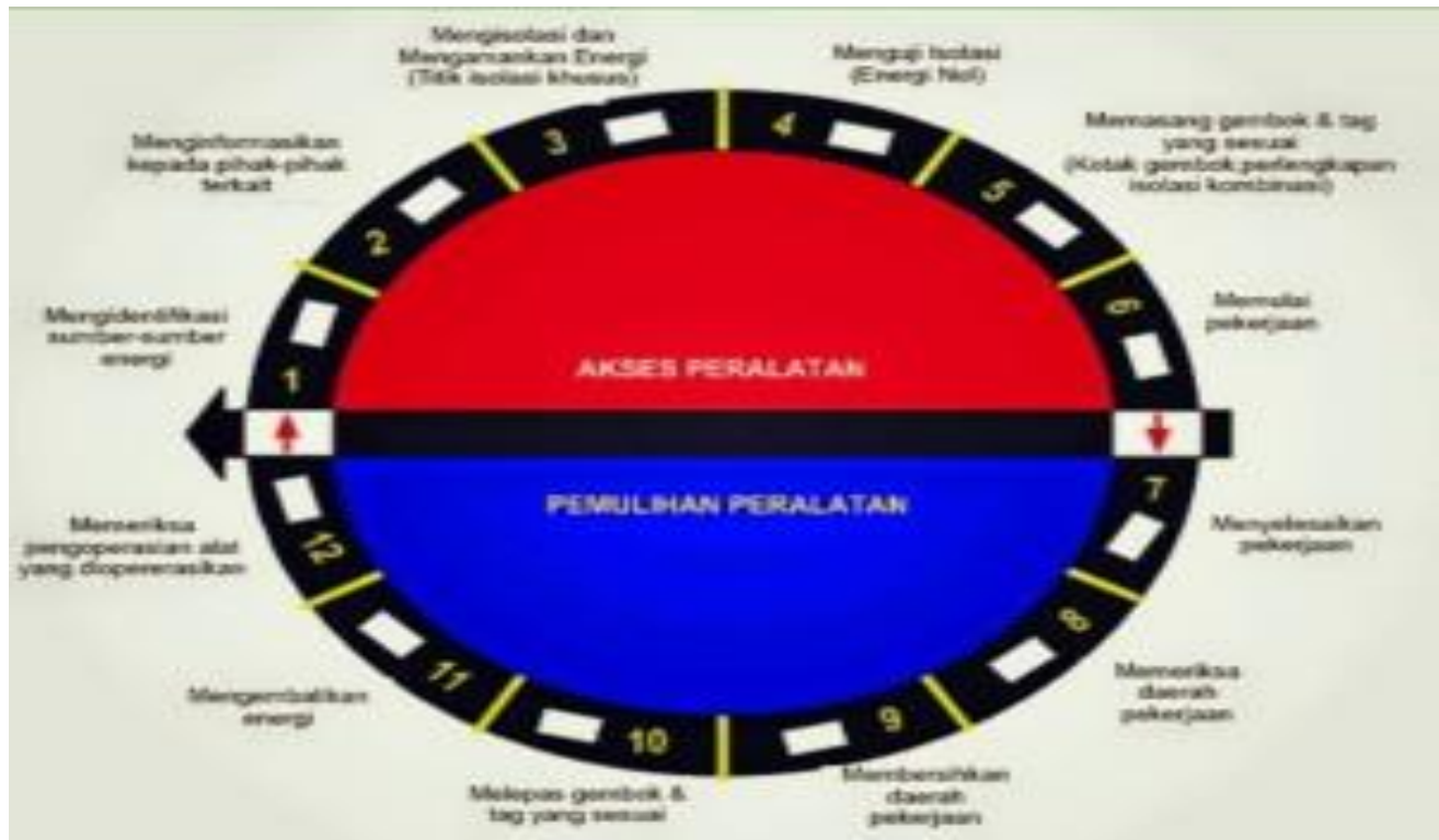
Gambar 10.6 Langkah Pemasangan LOTO
