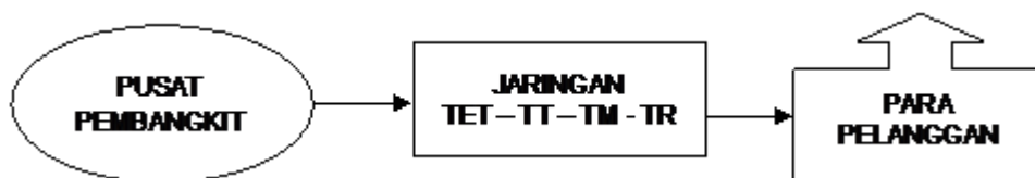
Gambar 10.1 Alur Jaringan Instalasi Listrik
