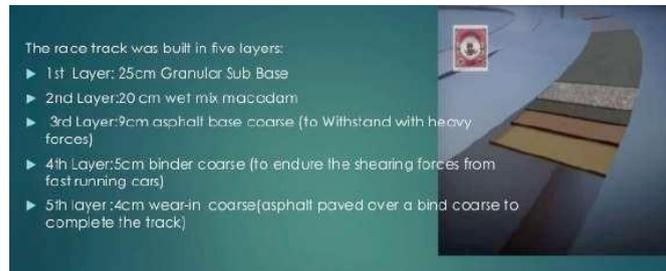
**Gambar 2.1** Lapisan bahan penyusun Lintasan
